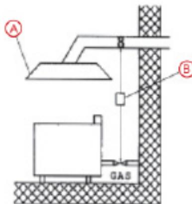
La hotte est ventilée sans évacuation naturelle. Les fumées sont aspirées à l'aide d'un ventilateur (évacuation forcée). Dans ce cas, il est nécessaire de prévoir un raccordement à l'alimentation en gaz pour couper l'alimentation en gaz en cas de défaillance de l'unité de ventilation.
